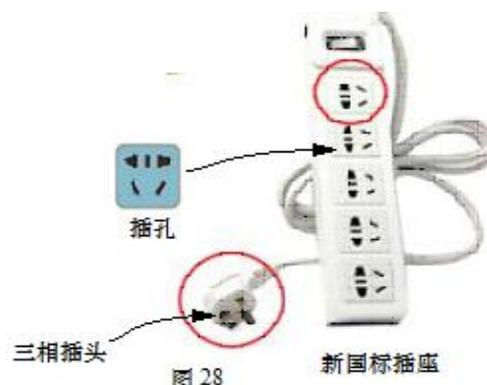
万用孔插座是老国标插座，此类插座因插孔较大，插座接片与电器插头接触面积过小，容易使插拔力过松、接触片过热，从而造成火灾事故的隐患。这类插座的电源线一端往往是两相插头，没有接地线。
