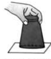
装满水的杯子，倒置后水没流出
