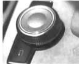
旋钮侧面制有条纹
