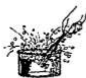
用发声的音叉接触水面时,水面水花四溅
