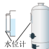
D. 锅炉水位计
