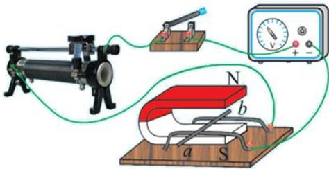
①闭合开关后, 观察导体 ab 的运动方向, 并记录在表格中。
