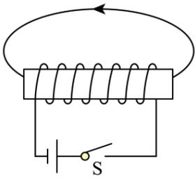
(3) [3]在通电螺线管内插入铁芯，首先铁芯被螺线管的磁场磁化，被磁化的铁芯的磁场和螺线管的磁场共同作用，磁场大大增强；而玻璃、铝、铜不会被磁化，故 ABC 不符合题意，D 符合题意。
