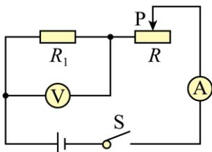
(2) 如图所示，闭合开关 S，调节滑动变阻器滑片 P，到适当位置，记录此时电流表示数为  $I_1$ 。用  $R_2$  替代  $R_1$  后，调节滑动变阻器滑片 P 直到电流表示数为  $I_1$ ，已知  $R_2$  不等于  $R_1$ ，发现电压表的示数不同，则电流与电阻的乘积不同，故这个实验说明  $I$  与  $R$  不成反比，所以小明的观点是错误的。
