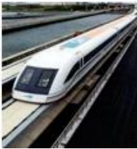
C. 行驶的磁悬浮列车车身不接触导轨
