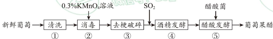
图 1 葡萄果醋发酵的工艺流程
