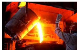
炼钢工人将回收的废铁化成铁水
