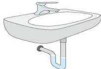
C. 洗手池下水的回水管
