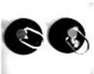
C. 将两个挂毛巾用的吸盘挂钩密压到一起. 用约 1N 的力向两侧拉, 就可以拉开
