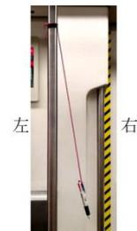
D. 该地铁在  $\Delta t$  时间内的速度变化量为  $\frac{Lg\Delta t}{\sqrt{L^2-d^2}}$
