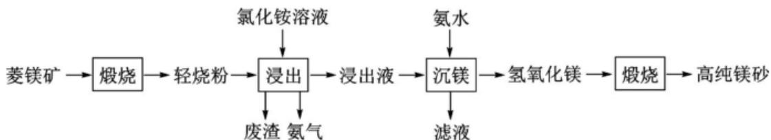
已知: 浸出时产生的废渣中有  $\text{SiO}_2$ 、 $\text{Fe}(\text{OH})_3$  和  $\text{Al}(\text{OH})_3$ 。
