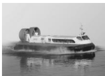
气垫船船底与水面分离 B
